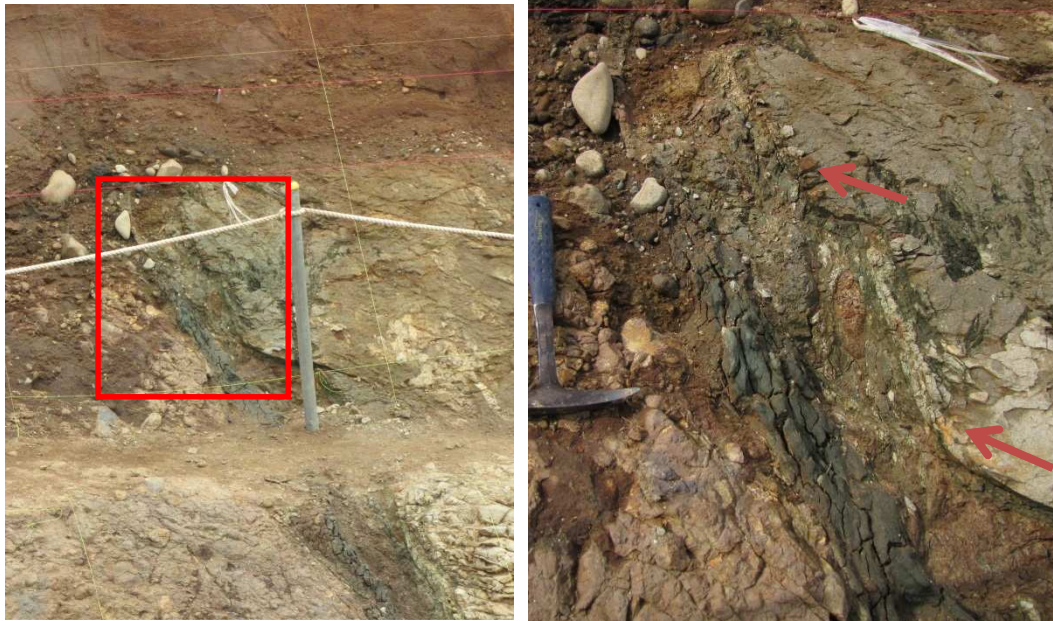
図-3 TR-28 の F3 断層上部。右図では、ガウジが矢印で示す岩盤の左上への突き上げによって変形を受け、一部は礫層の中に押し込められている。
