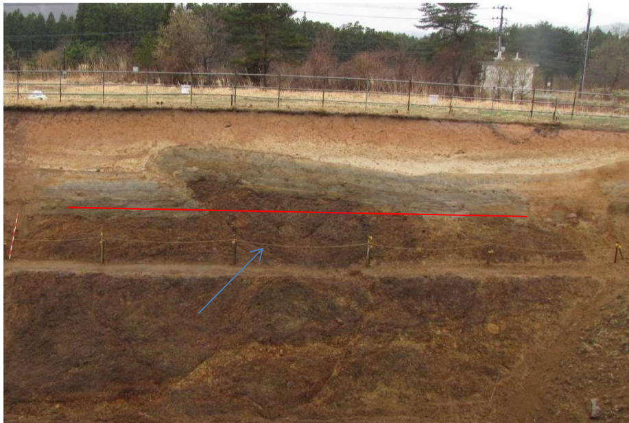
図-4 TR20' -1 の s-19. 右方に向けて低角化して消滅する様子が見える。また、断層から離れると岩盤面の高さが同じになる（直線）
