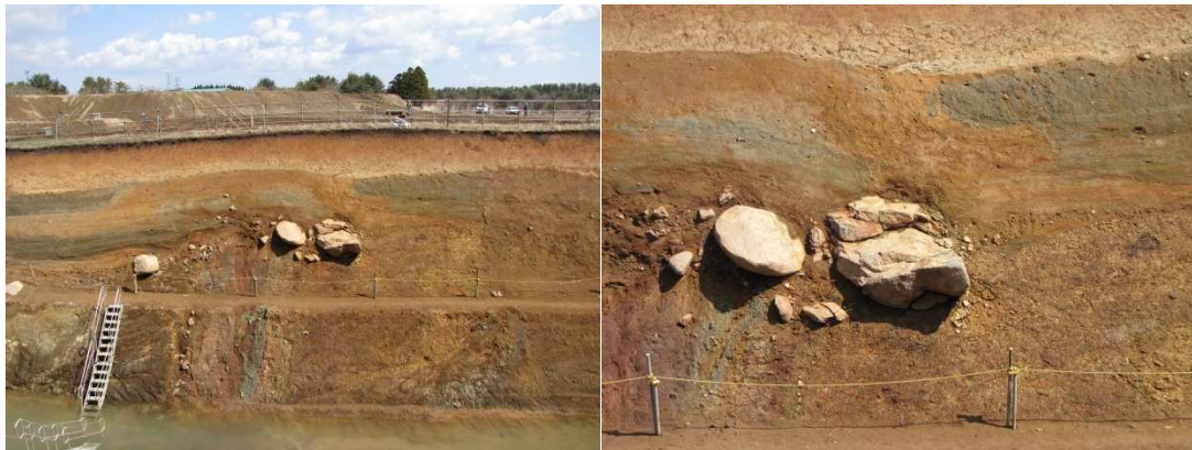
図一 1 TR-20'-2 北面の F-9 断層。断層の東側の凝灰角礫岩から上に向かい、次に西(左)にたなびく褐色の雲状のゾーンが見える。これは鉄の水酸化物の沈殿物であり、その形態から、凝灰角礫岩から絞り出された間隙水から沈殿したものである。
