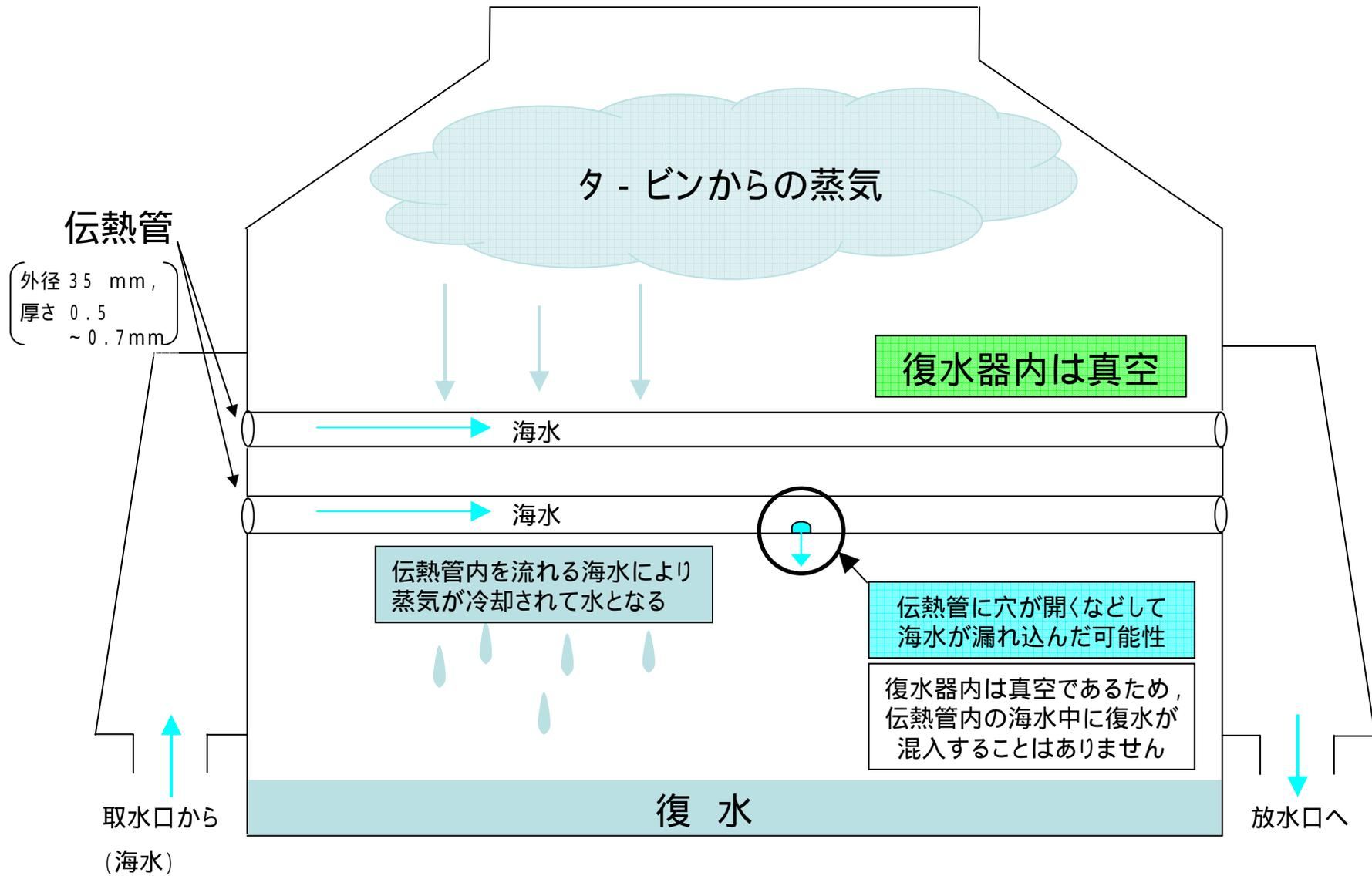
復水器伝熱管(細管)漏れ込みイメージ図
