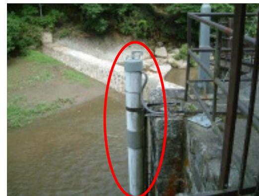
写真9 水位計測設備の設置
