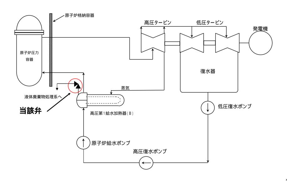
高圧第1給水加熱器(B)概略系統図
