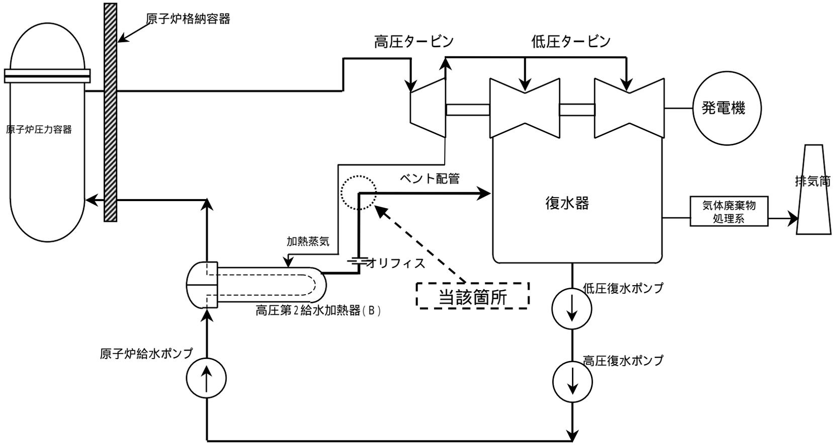
高圧第2給水加熱器 ( B ) ベント配管 概念図
