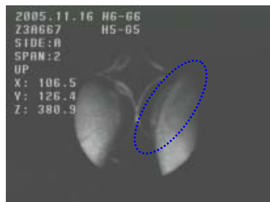
漏えい燃料棒で観察された 被覆管の微小な膨れ
