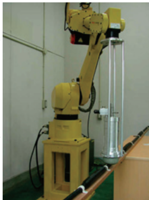
開発した移動型SQUID検査装置
