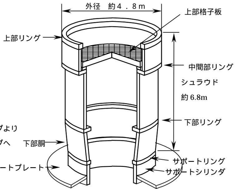
原子炉圧力容器概略図
