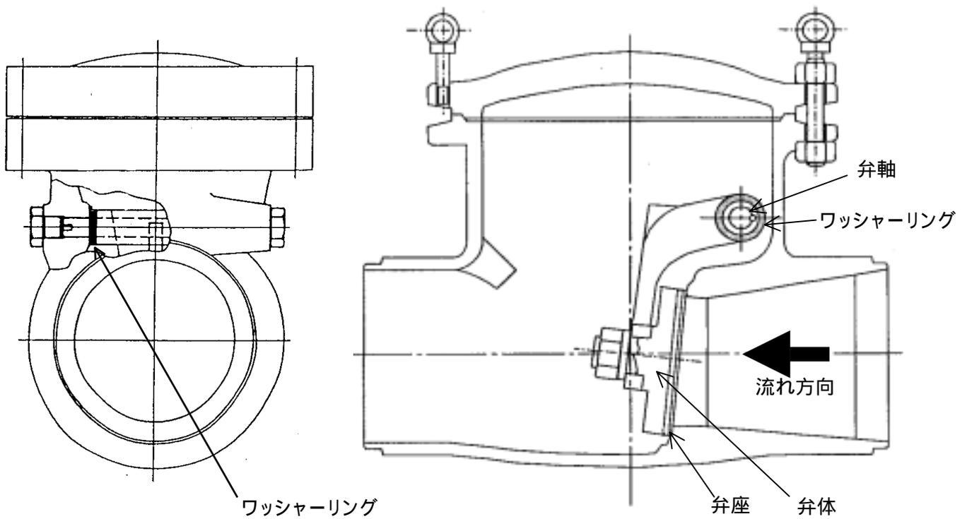
**給水系第1隔離弁(B) 構造図**
