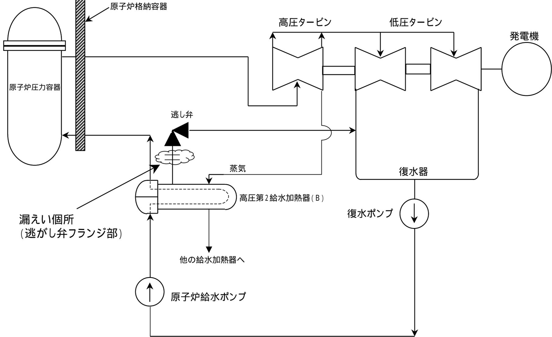
**高圧第2給水加熱器(B)概略系統図**
