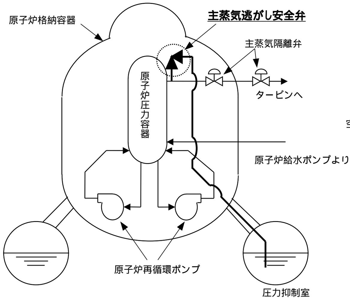
主蒸気逃がし安全弁系統概略図
