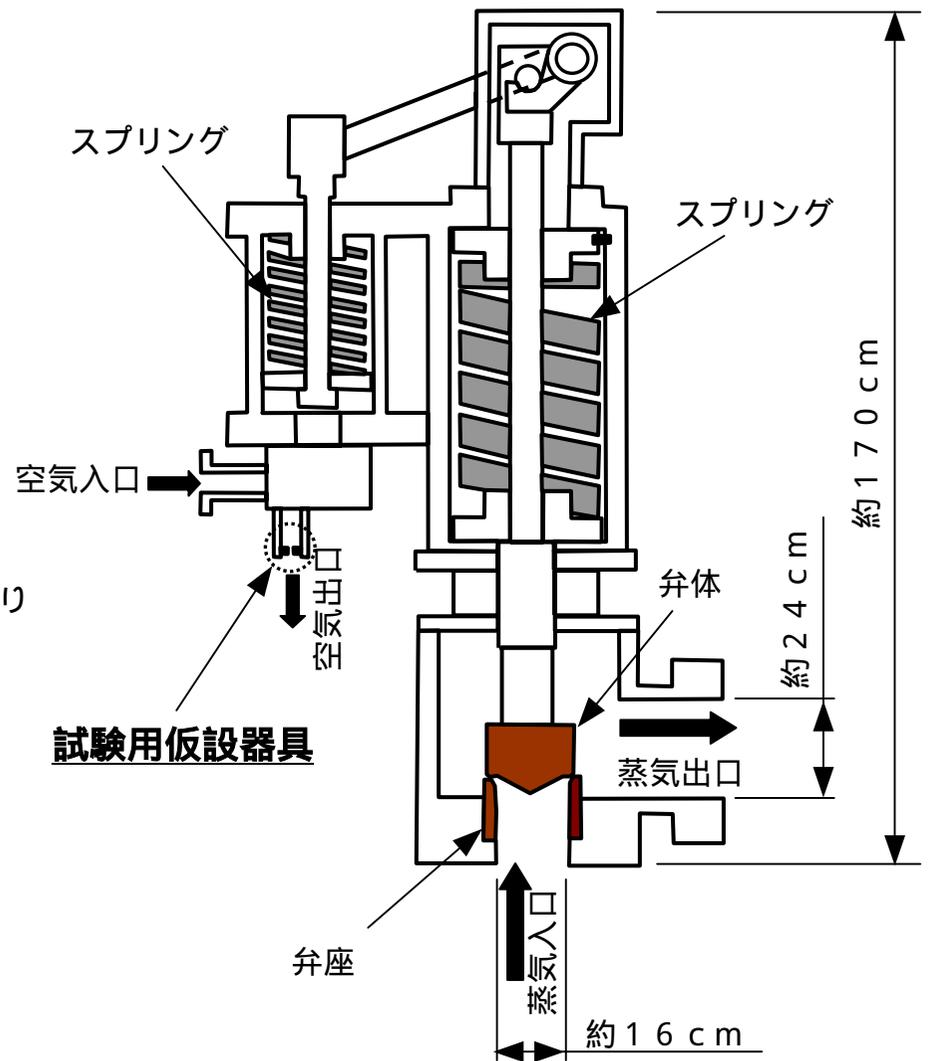
主蒸気逃がし安全弁概略図
