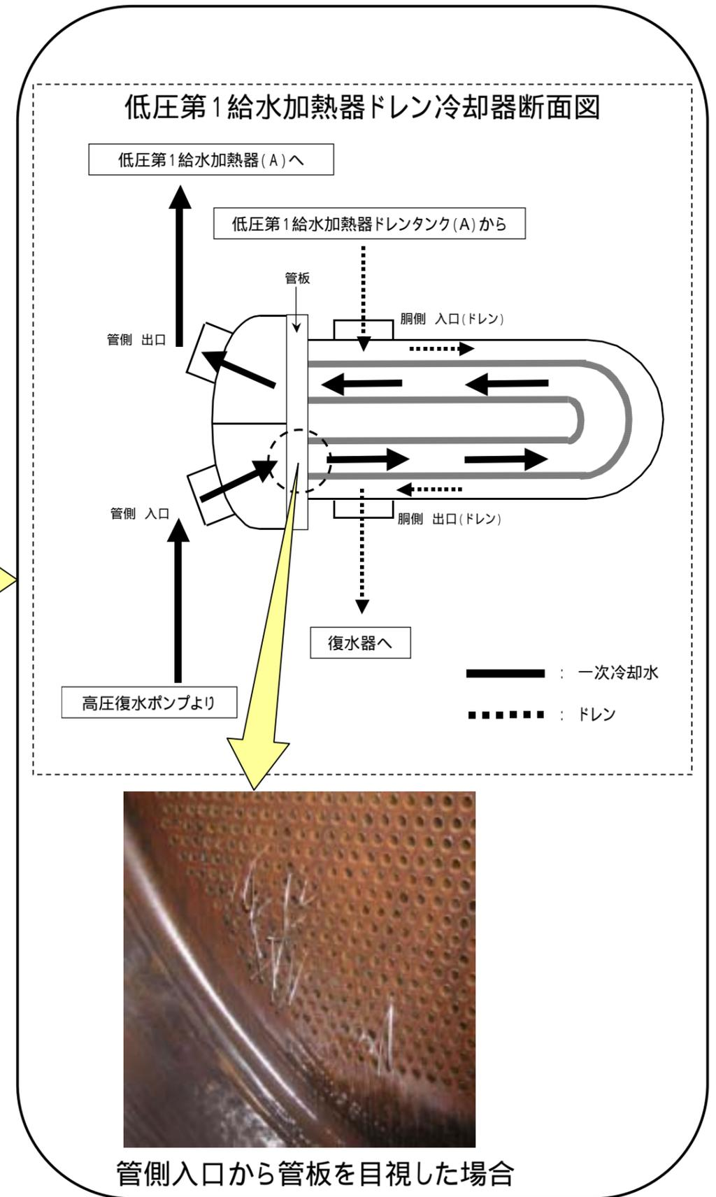
女川原子力発電所3号機 低圧第1給水加熱器ドレン冷却器における金属片について
