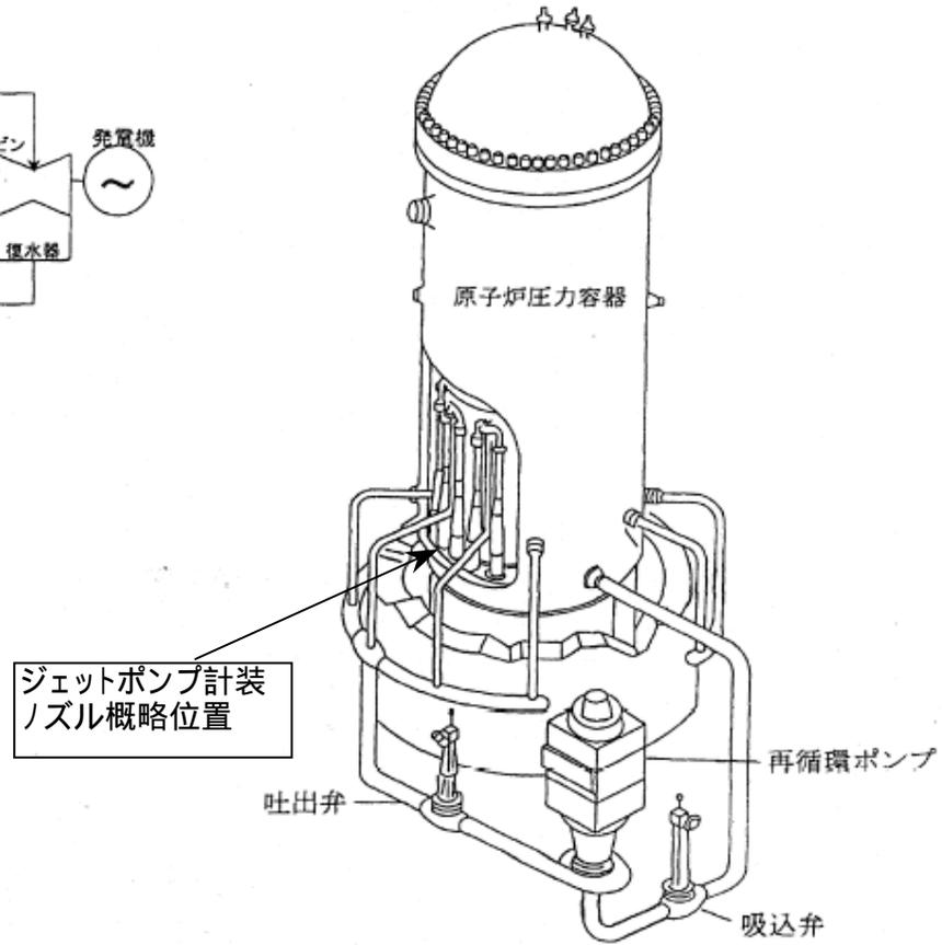
原子炉再循環配管鳥瞰図
