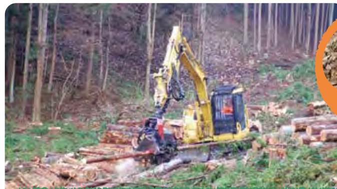
変電・送電線など建設工事で発生する伐採木をチップ化し、バイオマス燃料として活用
