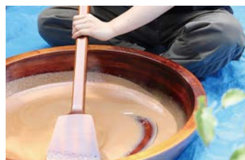
漆精製作業(漆くろめ)
