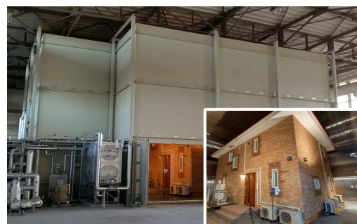
環境試験装置 (試験室内の実験用住宅)
