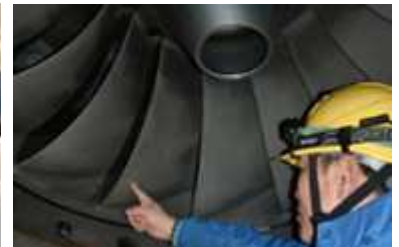
土砂・火山灰で磨耗する水力発電所の水車に開発コーティングを適用
