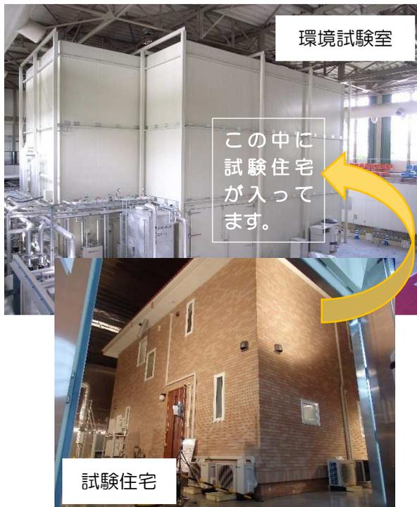
図1 環境試験室と試験住宅の外観
