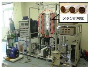
CO 2 メタン変換試験装置(ラボ装置)
