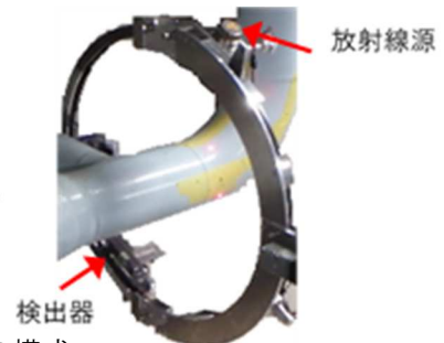
図2 3方向放射線透過法の測定原理
