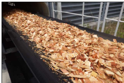
木材チップを石炭に混合 （混合量は重量比で石炭の約1%）
