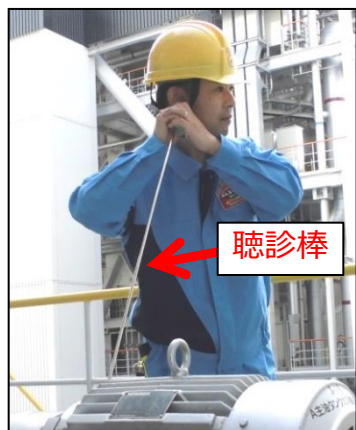
聴診棒を使用し、機器が発するわずかな異音から異常兆候を確認
