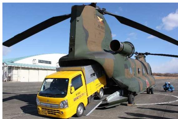
自衛隊のヘリコプター(CH47)で空輸対応型低圧応急電源車「ToMoS(灯(ともす)※)」を空輸する様子
