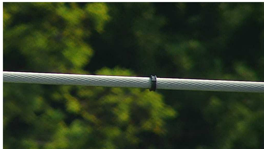
実証実験時にドローンが撮影した電線 (※) (直径 18.2 mm)
