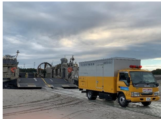
エアクッション型揚陸艦(LCAC)で高圧応急用電源車を海上輸送する様子
