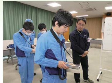
放射性物質との距離が離れるにつれて被ばく量が低減することを測定器を使って確認
