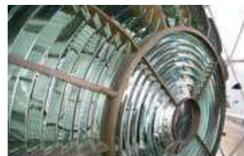
電球の光を増幅する2等フレネルレンズ
