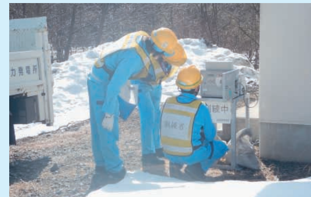
発電所構内に移動式のモニタリングポストを設置し、大気中の放射線量を測定しデータ収集を行った
