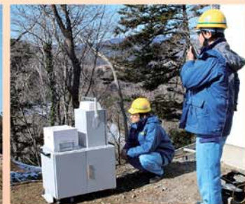
可搬型モニタリングポストの設置および測定訓練の様子
