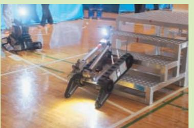
階段昇降やドアの開閉を行うロボットの様子
