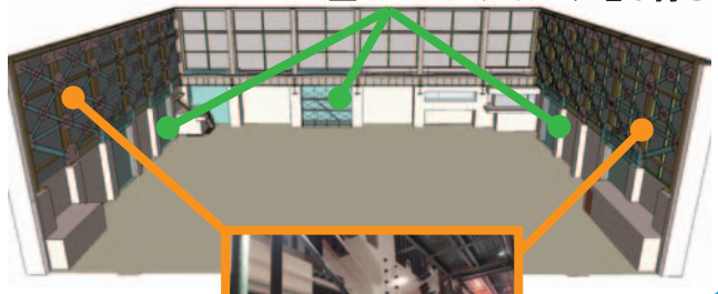
壁へのコンクリート増し打ち
