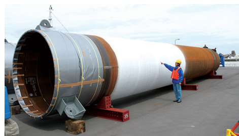
写真の鋼管杭は、直径 2.5m 長さ17.5m 重さ37.5 t
