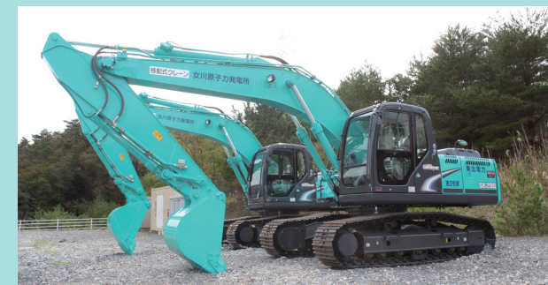
▶ 全長約9.4m、全幅約2.8mのバックホウ
