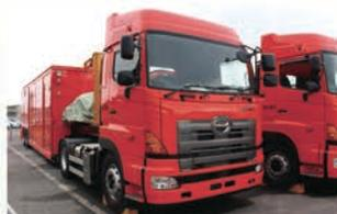
この車には、既設の熱交換器が使用できなくなった場合、その代わりになる装置を載せています。海水を汲み上げる送水ポンプ車と一緒に使うことで力を発揮します。津波の被害に遭わないよう高台に配備しています。
