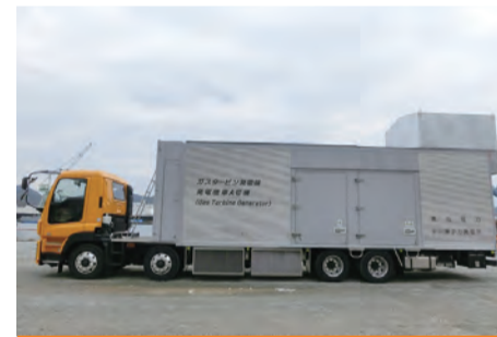
ガスタービン発電機(車両に搭載)
