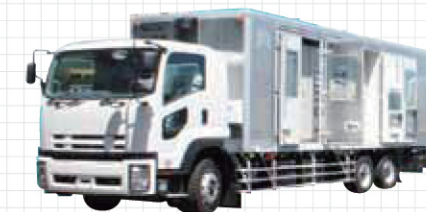
ガスタービン発電機を高台に配備予定
