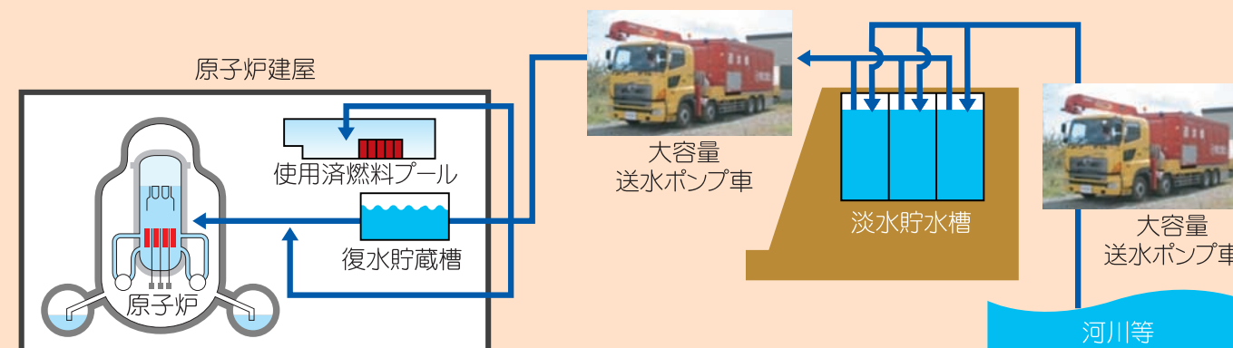
【淡水貯水槽から原子炉建屋内への水の流れ(イメージ図)】
