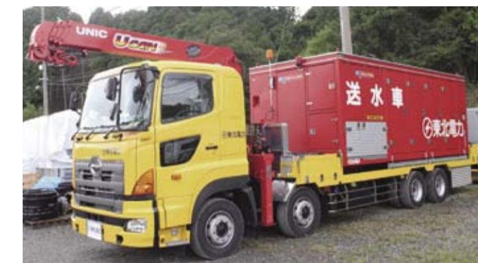
写真は配備済みの送水車
