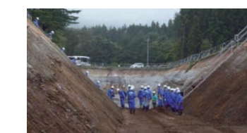
トレンチ調査 試掘溝を掘り、地形や地質分布、断層の性状等を調査
