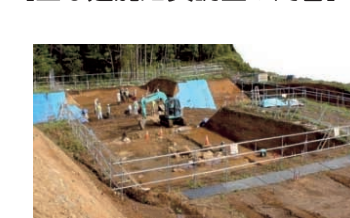
水平掘削面調査 断層直上の堆積層を段階的に水平に掘削し、横ずれ断層特有の構造の有無を調査
