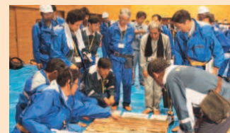
現地調査では断層破碎部のボーリング試料を確認
