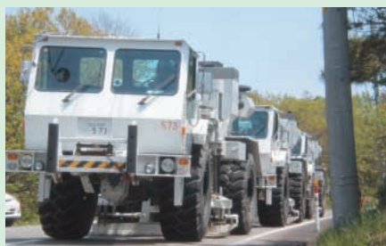
起震車による反射法地震探査
