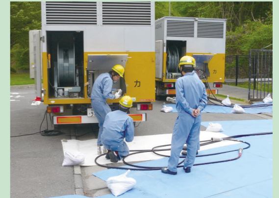
▲停電を想定したシミュレーターによる運転訓練（写真左）と高台に配置した高圧電源車による電源確保訓練（写真右）。緊急安全対策訓練には、発電所職員と協力企業社員あわせて約130名が参加し、真剣に訓練に取り組みました
