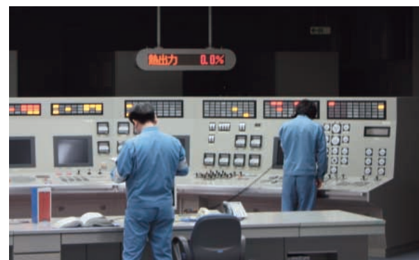
電源喪失を想定した運転員のシミュレータ訓練の様子 (技術訓練棟にて)
