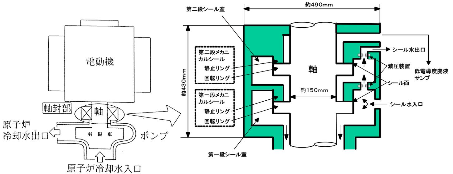
原子炉再循環ポンプメカニカルシール概念図
