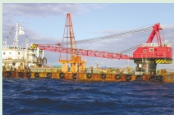
海底の地層を直接採取し分析する海上ボーリング調査
