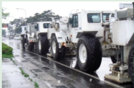
地下に振動を与え反射波をとらえて地下構造を把握する反射法地震探査
