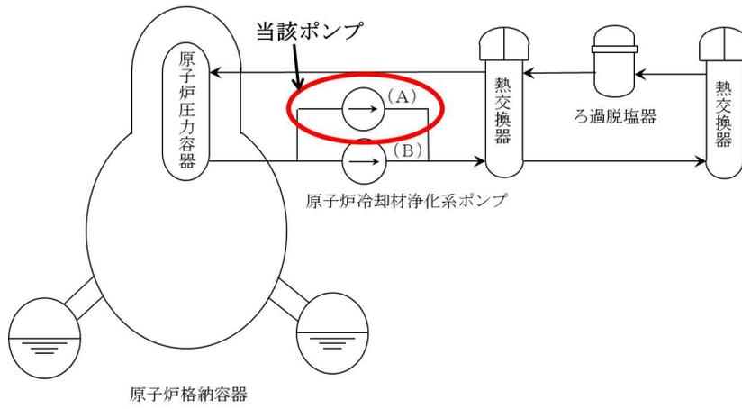
原子炉冷却材浄化系 系統概略図
