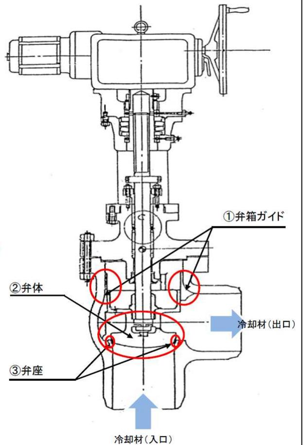
**残留熱除去系 A系第二注入隔離弁構造図**
