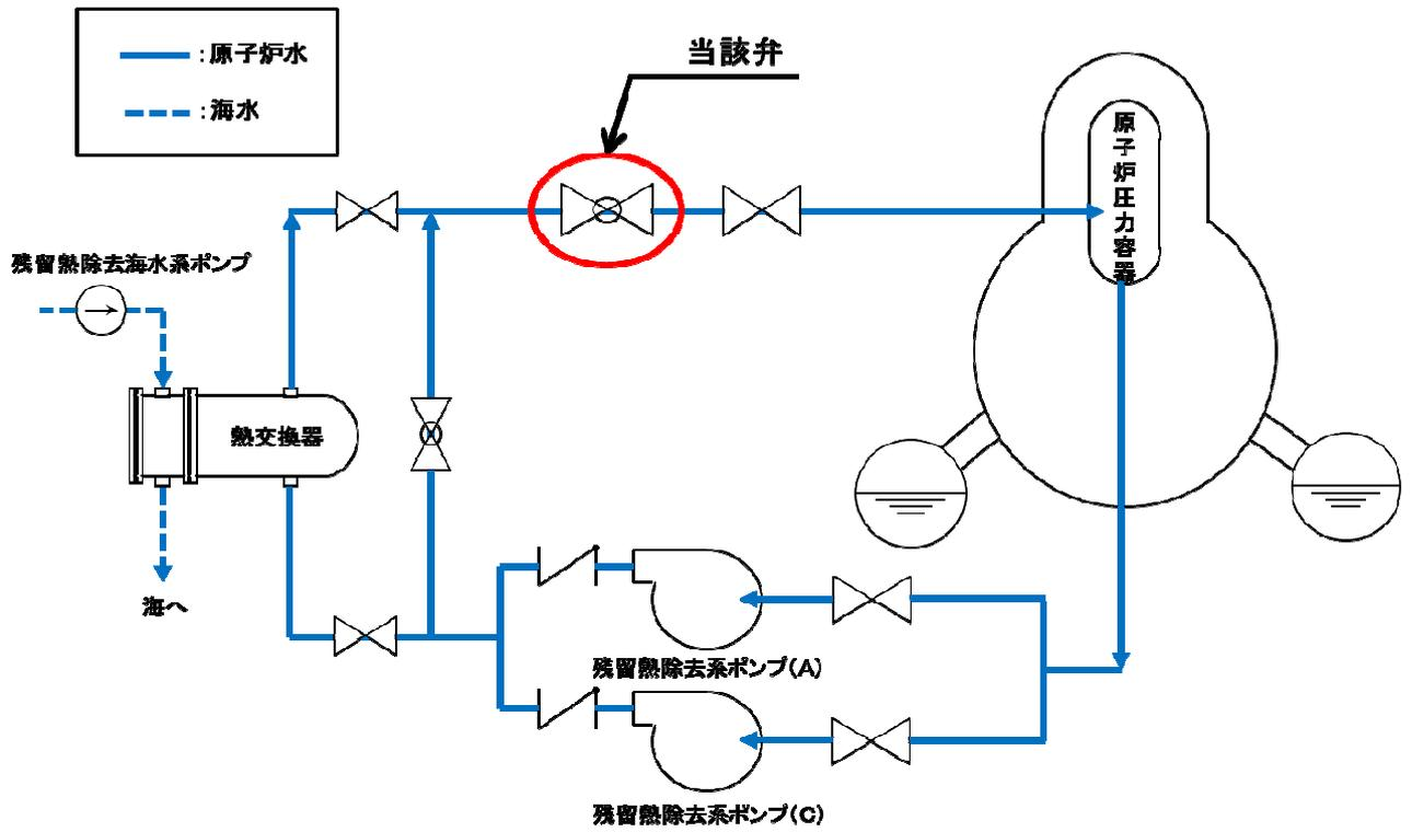
**残留熱除去系A系 系統概略図**
