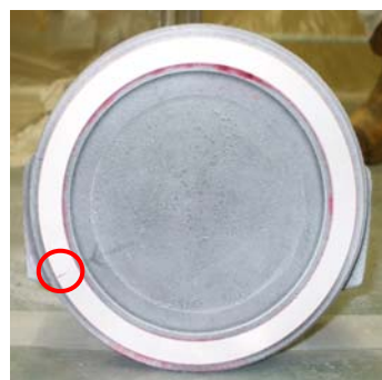
弁体シート面指示模様状況写真 (約6mm) ○：指示模様箇所
