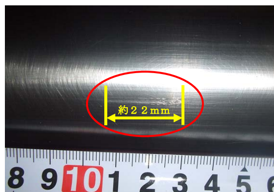
弁棒傷状況写真
