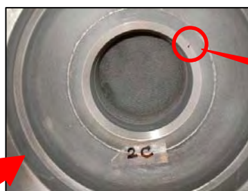
当該弁(2C)指示模様状況写真(約3.5mm)
