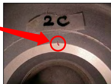
当該弁(2C)指示模様状況写真(約3.5mm)
