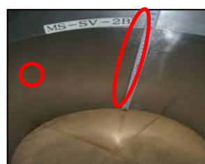
当該弁(2B) シリンダー摺動傷 (最大約3.06mm)
