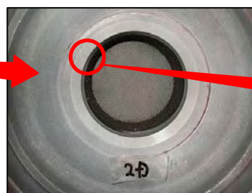
当該弁(2D)指示模様状況写真(最大約6mm)
