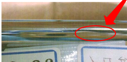
○：弁棒傷発生箇所
