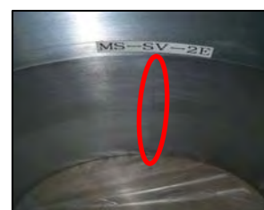
当該弁(2E) シリンダー摺動傷 (約2.58mm)
