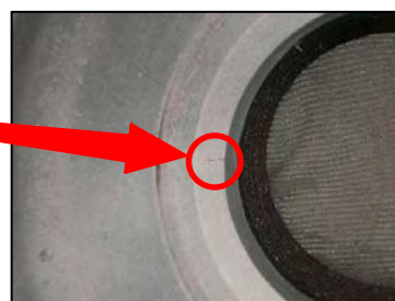
当該弁(2D)指示模様状況写真(最大約6mm)
