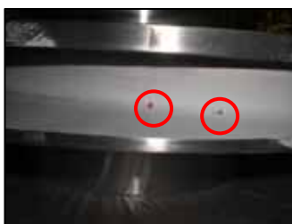
羽根車内部指示模様写真
