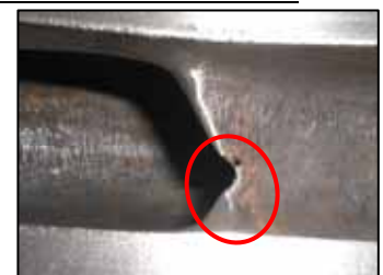
ケーシング減耗状況写真
