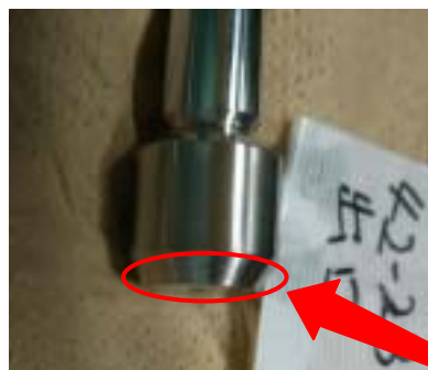
○：弁体腐食発生箇所
