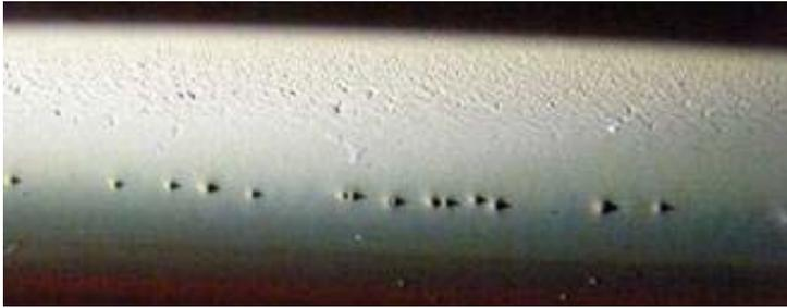
状況：保護棒間が選択的に浸食（梨地肌）を受け、一部で突起状（凸凹面）に残存していることが認められる。
