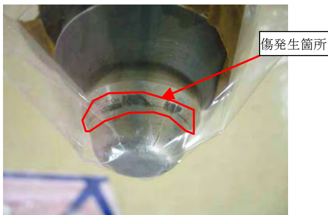
弁体傷状況写真
