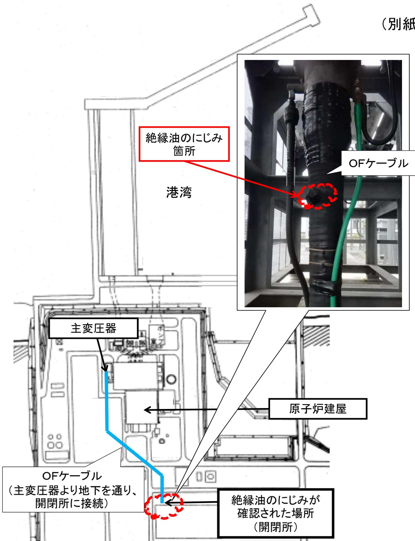
東通原子力発電所1号機 OFケーブルからの絶縁油のにじみ場所(概要図)
